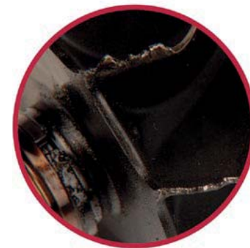
Schäden am Inducer des Verdichters oder der Turbinenschaufeln
