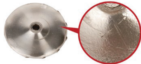
Orangenhauteffekt am Verdichterrad
