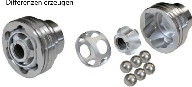
VL-Highspeed-Gelenke sind fahrzeugspezifisch unterschiedlich ausgelegt. Um Verschiebekräfte entsprechend auszugleichen, differieren beispielsweise die Kugelbahn-Winkel der VL-Gelenke bei Längswellen im Vergleich zum gleichen Gelenktyp bei Seitenwellen.
