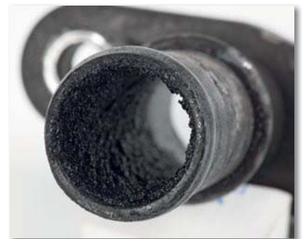
Abbildung 4: Durch eindringende Abgase verkockte Ölrücklaufleitung.
