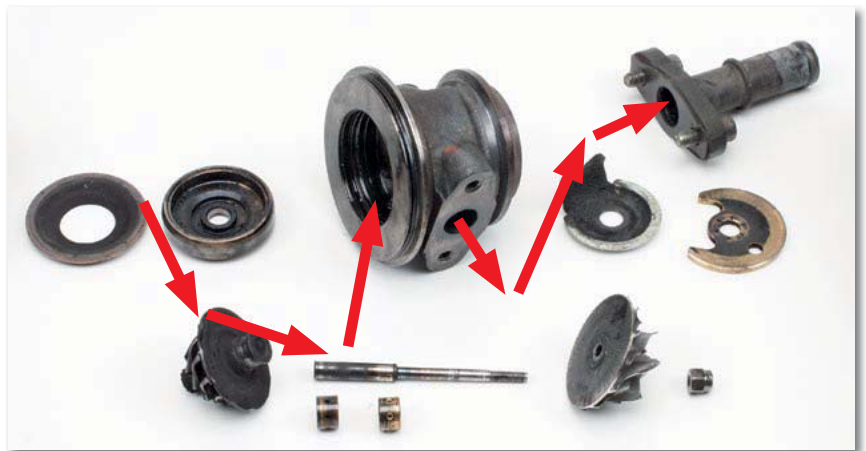
Abbildung 2: Weg der Abgase durch das Lagergehäuse
