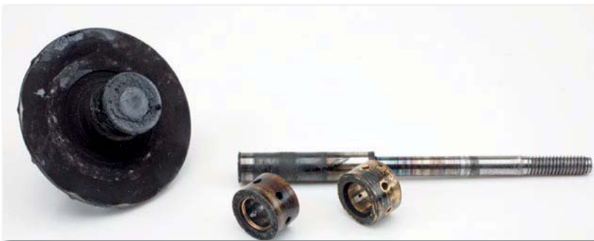
Abbildung 3: Gebrochene Läuferwelle aufgrund von Mangelschmierung der Radiallager
