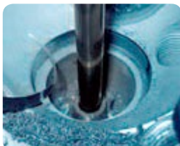
Bild 2: Nach dem Ausfräsen bleibt ein Reststück des Rings sichtbar.
