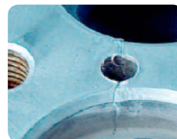
Bild 5: Ein gerissener Steg – Folge einer zu großen Überdeckung.
