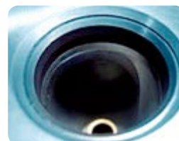
Bild 6: Das optimale Montageergebnis mit erneuertem Ventilsitzring.
