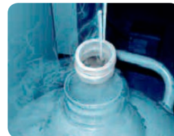
Bild 4: Zur Montageerleichterung werden die Ventilsitzringe mit flüssigem Stickstoff abgekühlt.
