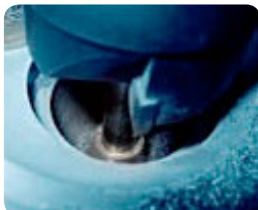
Bild 3: Der Fräskopf zum Bearbeiten des Sitzes des Ventilsitzrings.
