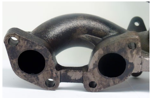
Abbildung 2: Öl dringt bereits am Turbineneintritt ein
