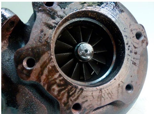
Abbildung 1: Öl am Turbinenaustritt des Turboladers
