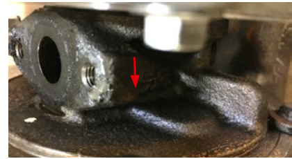
Im Bereich der Rumpffgruppe sind leichte thermische Verfärbungen sichtbar. Diese zeugen von einer thermischen Überbelastung der Rumpffgruppe durch wenig Kühlung durch geringen Öldruck und hohe Lagerreibung.
