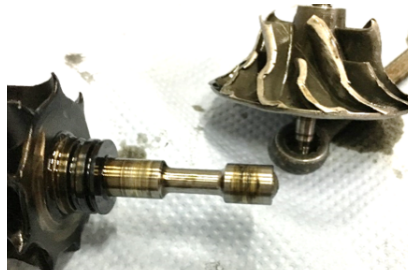
Die Turbinenwelle weist Kontaktschäden des Radiallagers an den Lagersitzen aus. Beleg dafür sind die messingfarbigen Auftragungen von Lagermaterial. Aber warum passiert das?
