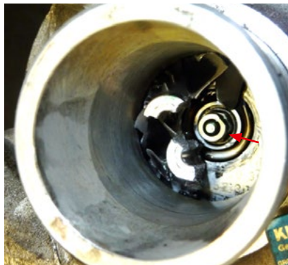
Das Verdichterrad ist in drei gleiche Teile zerbrochen. Die Ursache liegt in der Massengleichheit. Turbolader werden bei 150.000 U/min auf 5mg ausgewuchtet. Infolge der Fliehkraft verteilt sich das Material des Verdichterrads nach außen und zerreißt das Verdichterrad im Winkel von 120°. Die Sicherungsmutter sitzt noch auf der Turbinenwelle.
