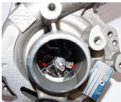
Verdichterrad angestrichen und Turbinenwelle gebrochen. Die Lufteintrittskanten sind unbeschädigt. Die Sicherungsmutter sitzt noch auf der Turbinenwelle.
