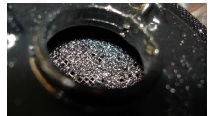
Ist das Sieb erst verstopft, fehlt Öldruck an den Lagerstellen. Leider leuchtet unsere Ölkontrolle am Motor erst bei Öldrücken je nach Programmierung unter 0,3 - 0,7 bar auf. Da kommt für einen Turbolader mit Arbeitsdrehzahl jede Hilfe zu spät.
