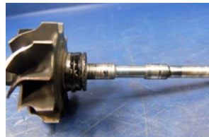
Stufe 2 Starker Materialabrieb: Übertrag von Lagermaterial auf Welle
