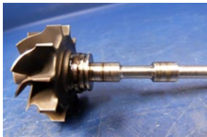
Stufe 1 Leichter Materialabrieb: Übertrag von Lagermaterial auf Welle
