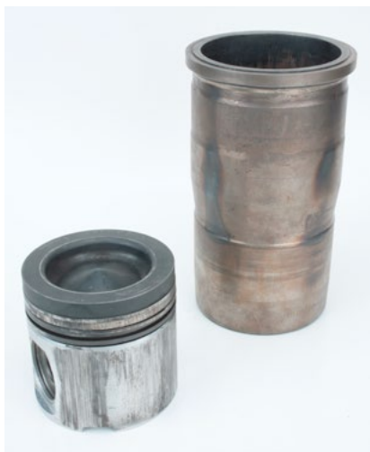
Abbildung 1: Überhitzter Ferrotherm-Kolben (Kolbenkopf aus Stahl und Schaft aus Aluminium) mit Fressspuren und dazugehöriger Laufbuchse.
