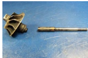
Stufe 4 Verkockt und gebrochen. Der Wellenbruch führte zum abruptem Wellenstopp und Verlust der Wellenmutter vom Verdichterrad (Linksgewinde). Auf dem Verdichterrad Einschlagspuren der gelösten Wellenmutter.
