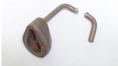
Abbildung 2: Kühldüse eingebaut (oben) und abgebrochen (unten)
