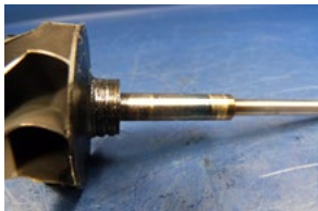
Stufe 3 Starker Materialabrieb und Überhitzung Verkokung der Welle und Blauerfärbung
