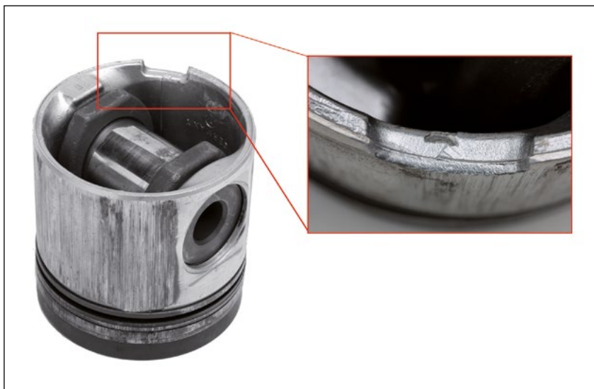
Abbildung 3: Erkennbare Spuren am Kolbenschaft weisen auf einen Einschlag der Kühldüse hin.
