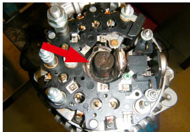
Ölrückstände im Generator
