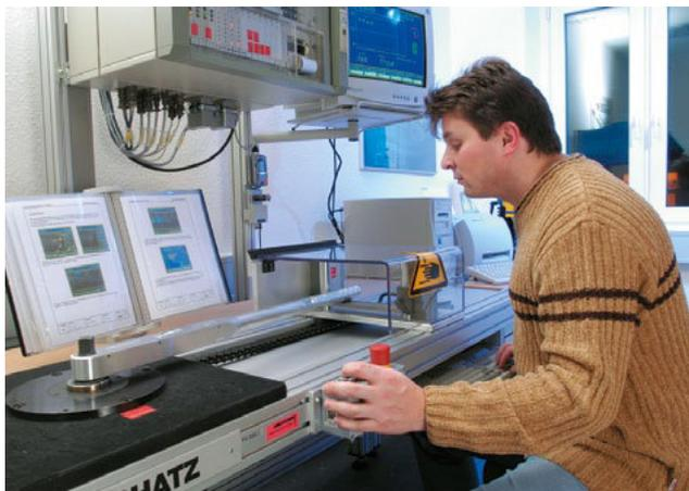
Jeder Drehmomentschlüssel erfüllt die Bedingungen der DIN EN ISO 6789 in einem gewissen Toleranzbereich, d.h. die eingestellten Drehmomentwerte können zu einem festgelegten Prozentsatz über- bzw. unterschritten werden. Ein einmal kalibrierter Drehmomentschlüssel muss zur Gewährleistung seiner Genauigkeit regelmäßig überprüft werden. Die DIN EN ISO 6789:2003 empfiehlt eine jährliche Kalibrierung oder nach 5000 Lastwechseln. Bei intensiverem Einsatz oder sicherheitsre-
