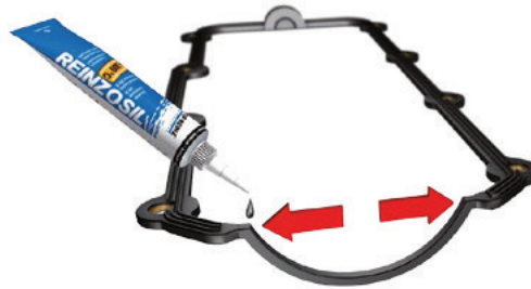
Abbildung 3_Dichtmasse an den Ecken des Nockenwellenhalbbogens
