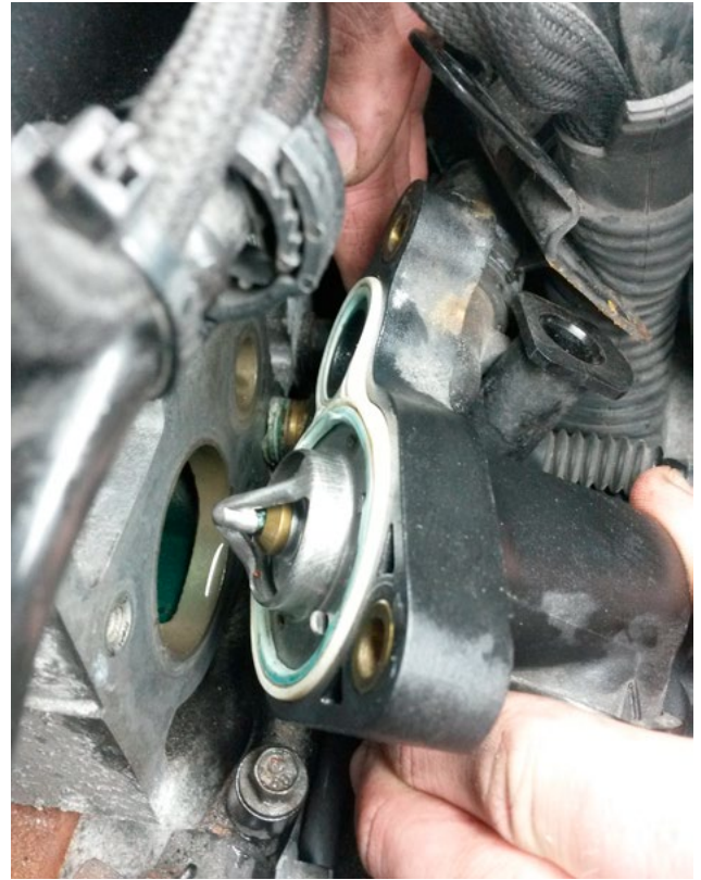
Abbildung 1: Wird der Kühlkreislauf geöffnet, tritt Kühlwasser aus und Luft in das System ein.
