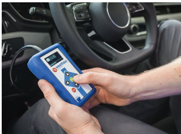
Lösung 1: Verwendung eines fahrzeugspezifischen Westfalia-Elektrosatzes (Codierung erforderlich)
